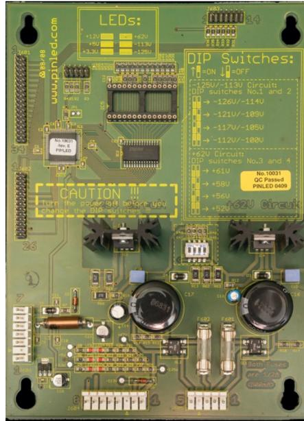
**DE** - Spannungseinstellung mit den DIP-Schaltern. Hier können niedrigere Spannung eingestellt werden. Dieses dient zur Lebensverlängerung von neuen Displays. Ältere Displays bitte mit voller Spannung betreiben.
